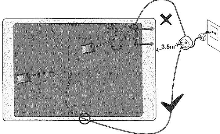
> Immerger le nettoyeur dans la piscine. Attendre que les bulles cessent complètement et laisser le nettoyeur couler jusqu'au fond de la piscine. **Immerger tout le câble dans la piscine pour vous assurer que le nettoyeur a une portée suffisante pour tourner et couvrir toute la zone de la piscine.**
